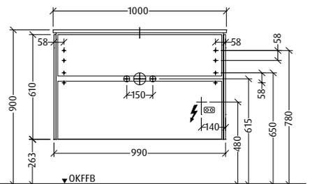
**N L** 220 - 240 V loser Netzanschluss (laut VDE 0100 Teil 701) bei Set SL250/SL251
