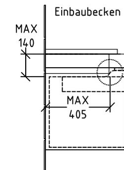
→ Es kann KEIN Hebelgestänge montiert werden!
