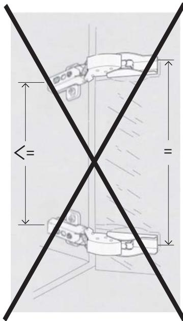
**Achtung:** Der Höhenabstand zwischen Verstellplatten (Korpus) und Scharnieraufnahme (Spiegel) muss gleich sein, damit die Spiegeltüren spannungsfrei montiert werden können!
